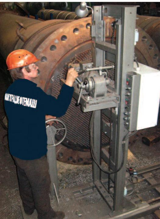
**Рисунок 6.** Установка для торцевания и высверливания труб МЭТ-2 в работе
