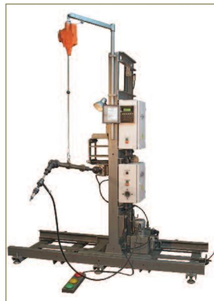
Рисунок 2. Установка для развальцовки труб МЭР–11М
