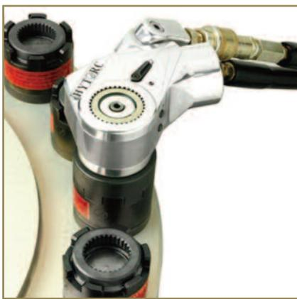
**▲** Рисунок 10. Работа стандартной болтинг-машины с гайкой-натяжителем HYTORC через спецпривод
