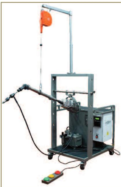
Рисунок 4. Передвижная установка для развальцовки труб МЭР-16М.
