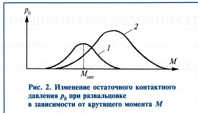
**Рис. 2. Изменение остаточного контактного давления  $p_0$  при развалцовке в зависимости от крутящего момента  $M$**
