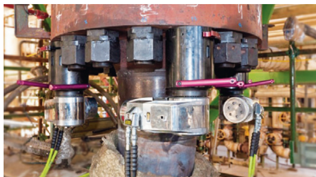
Рис. 4. Гидравлическая система Simultorc из четырех болтинг-машин
