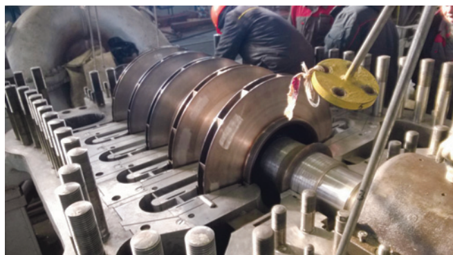
Рис. 3. Модернизированный ротор ЦНД
