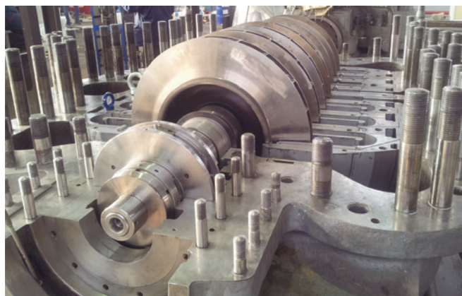
Рис. 4. Модернизированный ротор ЦВД
