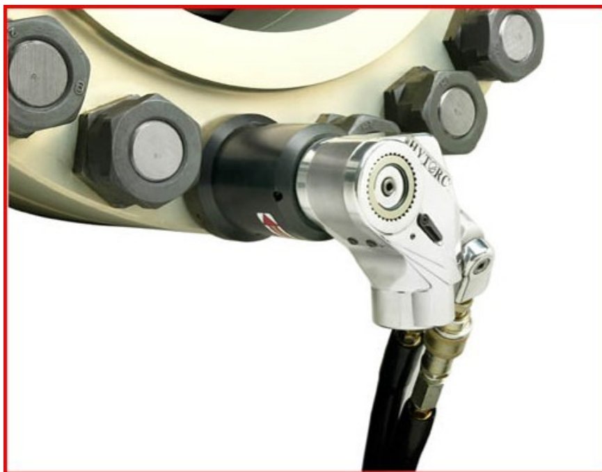
Рис. 21. Работа стандартной болтинг-машиной моментом-натяжением без упора и обратного ключа с помощью шайбы HYTORC и опорного стакана.
