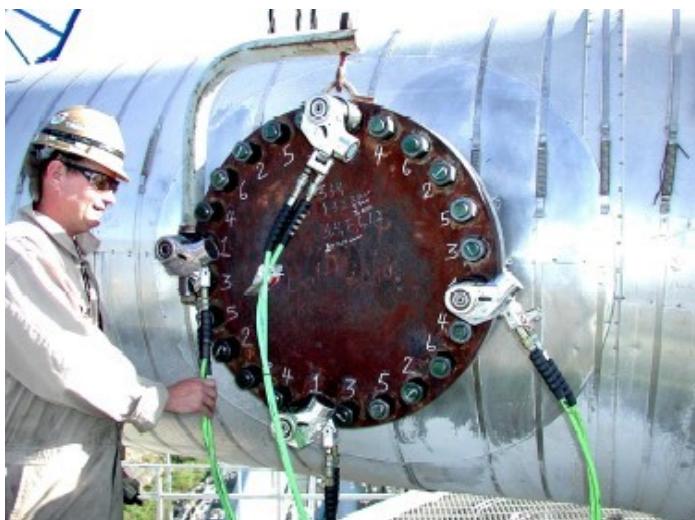
Рис. 12 Гидравлическая система Simultorc из 4-х болтинг-машин.
