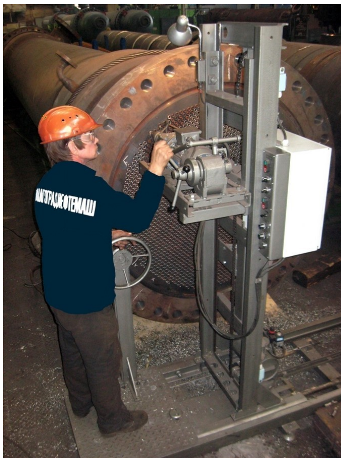
Рис. 11 Установка для торцевания и высверливания труб МЭТ-2 в работе.
