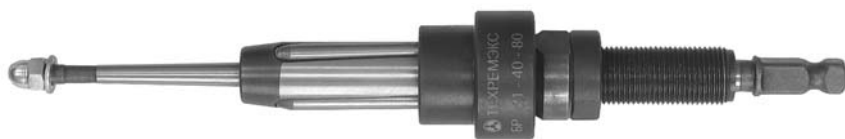
Рис. 1. Вальцовка «БР» (самый распространенный тип вальцовки)
