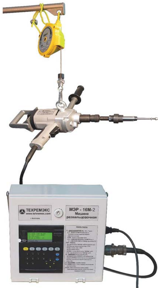
Рис. 8. Машина для развальцовки труб МЭР-16М-2
