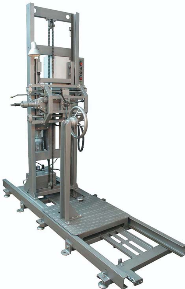
Рис. 9. Установка для торцевания и высверливания труб МЭТ-2
