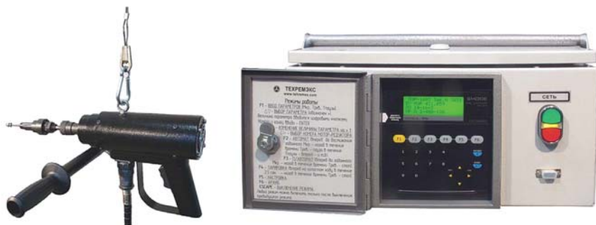
Рис. 7. Машина для развальцовки труб МЭР-16М-3-24
