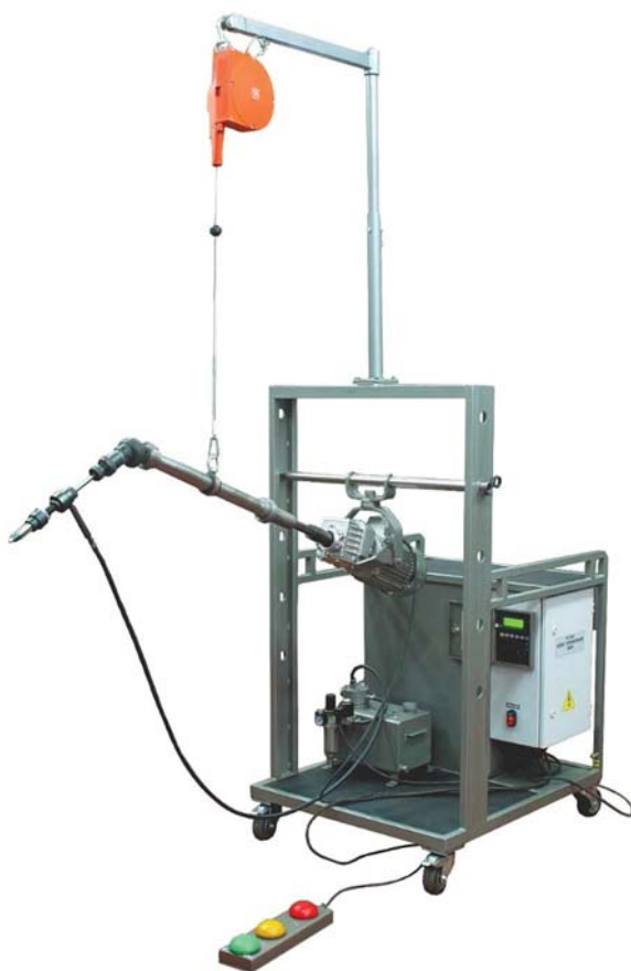
Рис. 6. Передвижная установка для развальцовки для труб МЭР-16М
