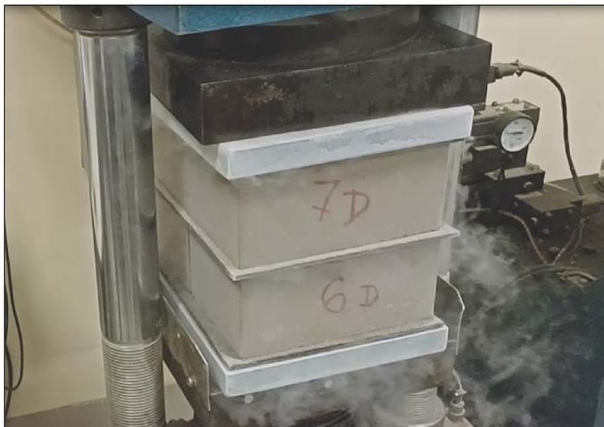
**Рис. 4.** Испытание двойной кладки на гидравлическом стенде после выемки из изотермического бокса (6D, 7D)
