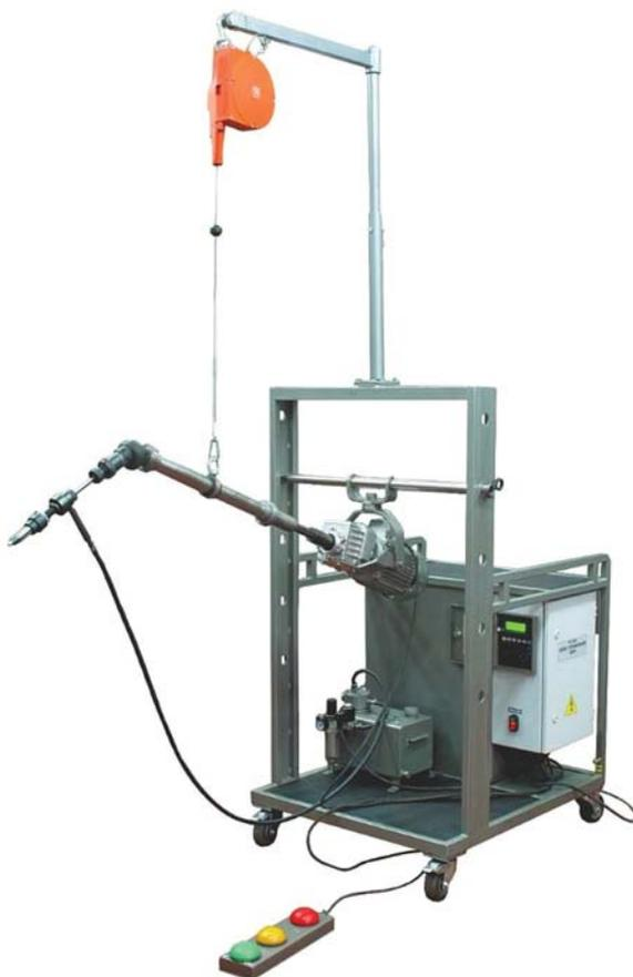
**Рис. 6.** Передвижная установка для развальцовки для труб МЭР-16М
