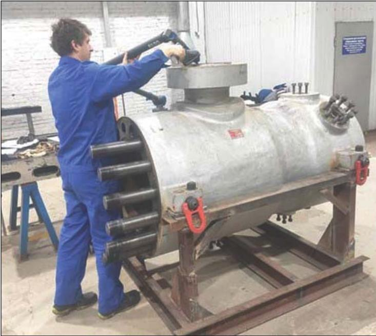
**Рис. 3.** Процесс снятия размеров с изделий
