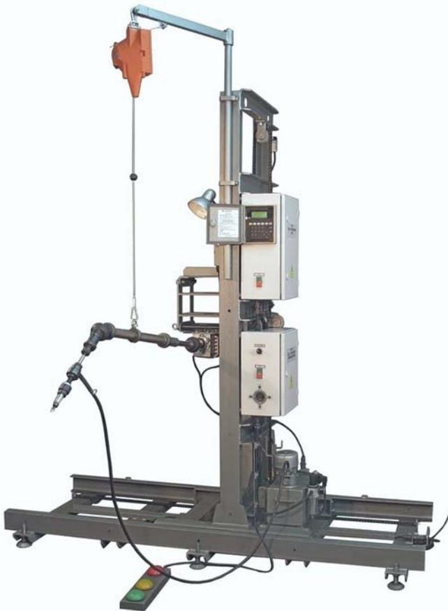
Рис. 4. Установка для развальцовки труб МЭР-11М
