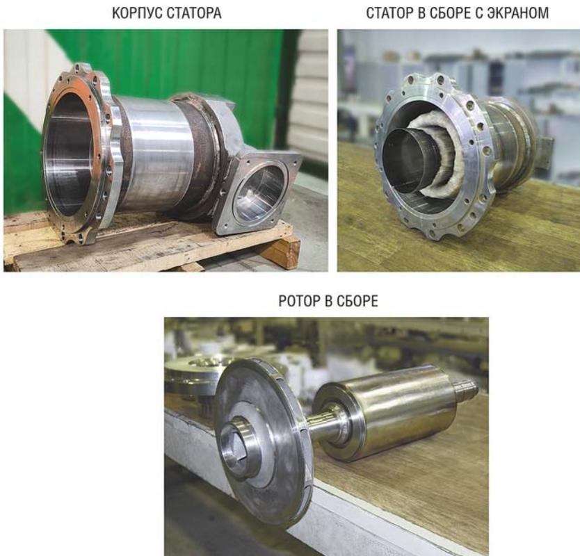
**Рис. 2.** Элементы экранированного электродвигателя электронасосного агрегата
