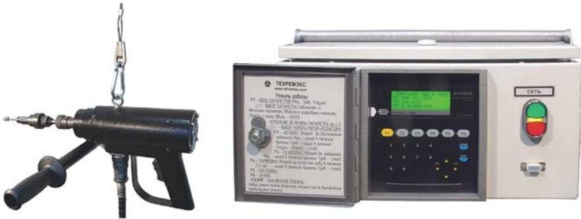
Рис. 7. Машина для развальцовки труб МЭР-16М-3-24
