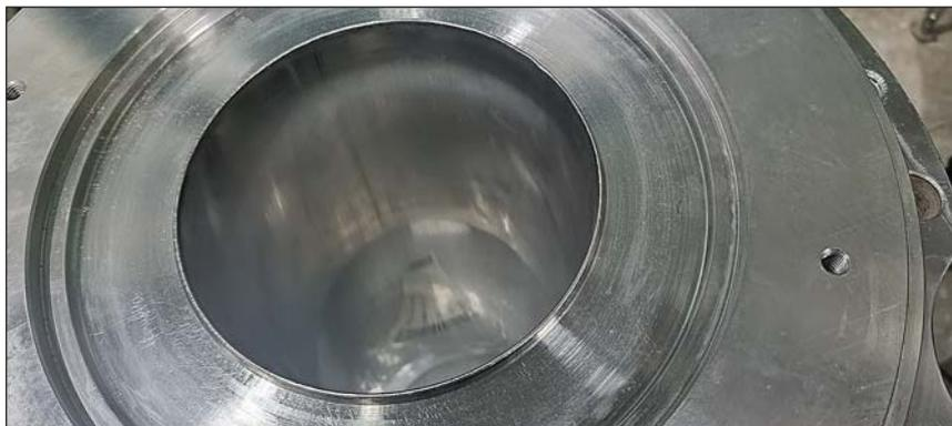
Рис. 3. Экранирующая гильза статора
