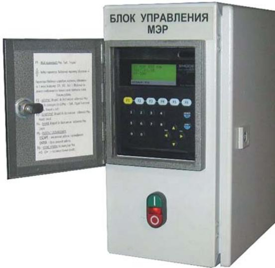
Рис. 5. Блок управления МЭР
