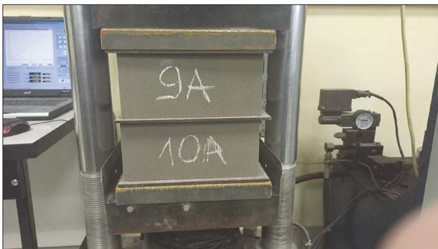
**Рис. 5.** Испытание двойной кладки на гидравлическом стенде при положительной температуре (9А, 10А)
