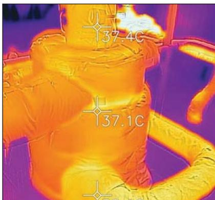
Рис. 2. Термочехол в тепловизоре
