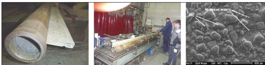
**Рис. 2.** Элементы трубопровода для подачи суспензии гудрона и угольной добавки с температурой до 400 °С на установку по глубокой переработки тяжелых остатков перегонки нефти
