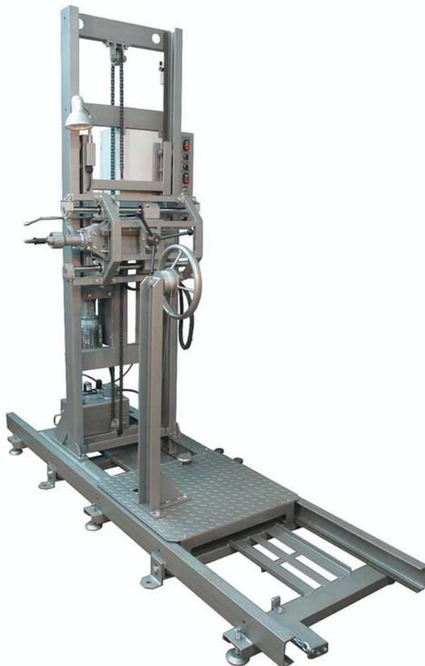
**Рис. 9.** Установка для торцевания и высверливания труб МЭТ-2
