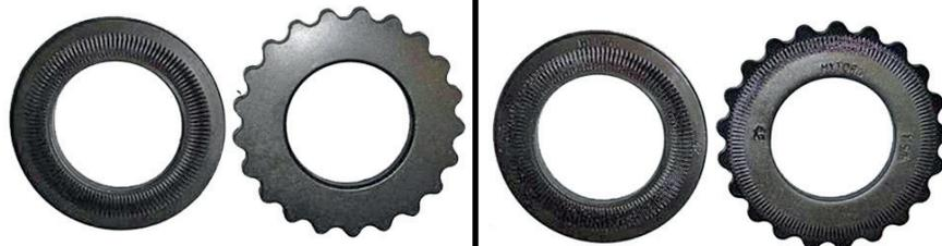
сосудов и аппаратов позволяют радикально купировать возможные утечки во время эксплуатации. С активной стороны шлицевая шайба устанавливается под гайку. Гидравлическим, пневматическими электрическим гайковертам требуется упор противодействующей силы, который опирается о неподвижную точку. Шайба сама по себе является точкой опоры.
