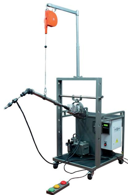
Благодаря удобной компактной стойке на колесном шасси, на которой располагаются основные узлы установок, а также высокой производительности, идеально подходит как для крупных изготовителей теплообменных аппаратов, так и для ремонтных производств нефтехимического комплекса. Предназначена для развальцовки труб наружным диаметром от 16 до 38 мм, при этом наибольший внутренний диаметр теплообменного аппарата, развальцовываемого без перемещения установки достигает 1500 мм.
