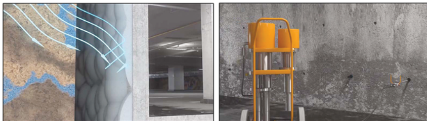
Создание сплошной мембраны, защищающей от протечек
