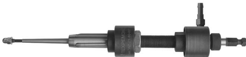
Рис. 2. Вальцовка «АР» (самый распространенный тип вальцовки)
