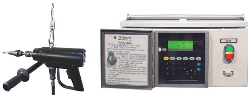
Рис. 7. Машина для развальцовки труб МЭР-16М-3-24
