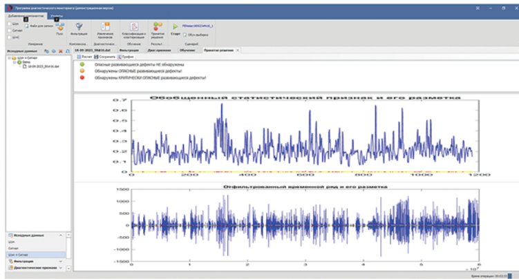
Иллюстрация отображения информации о степени опасности выявленной трещины в системе принятия решения
