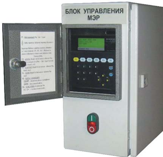
Рис. 5. Электронная система управления развальцовкой
