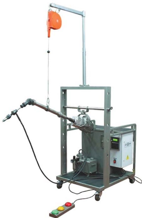
Рис. 6. Передвижная установка для развальцовки для труб МЭР-16М
