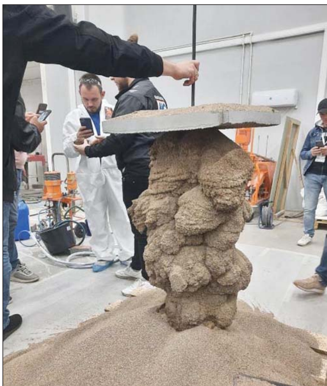
Распространение материала в грунте на макетных испытаниях
