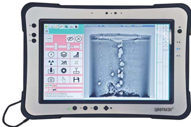
Рис. 7. Коррозия на планшете
